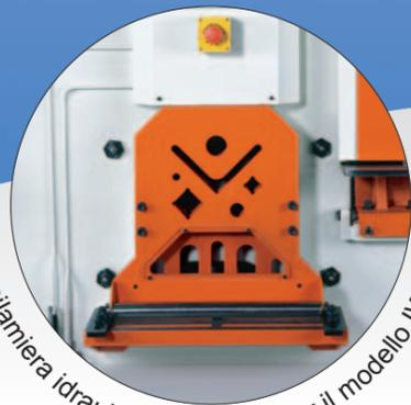
Premilamiera idraulica (opzionale per il modello IW-45K)
